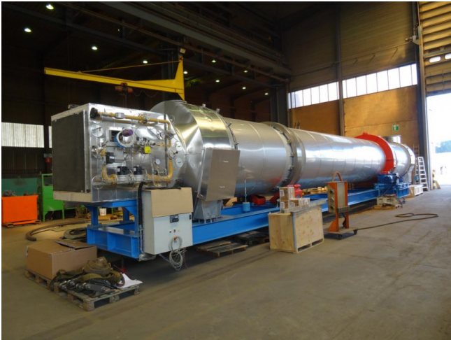
Figure 4 : exemple de séchoir à tambour
