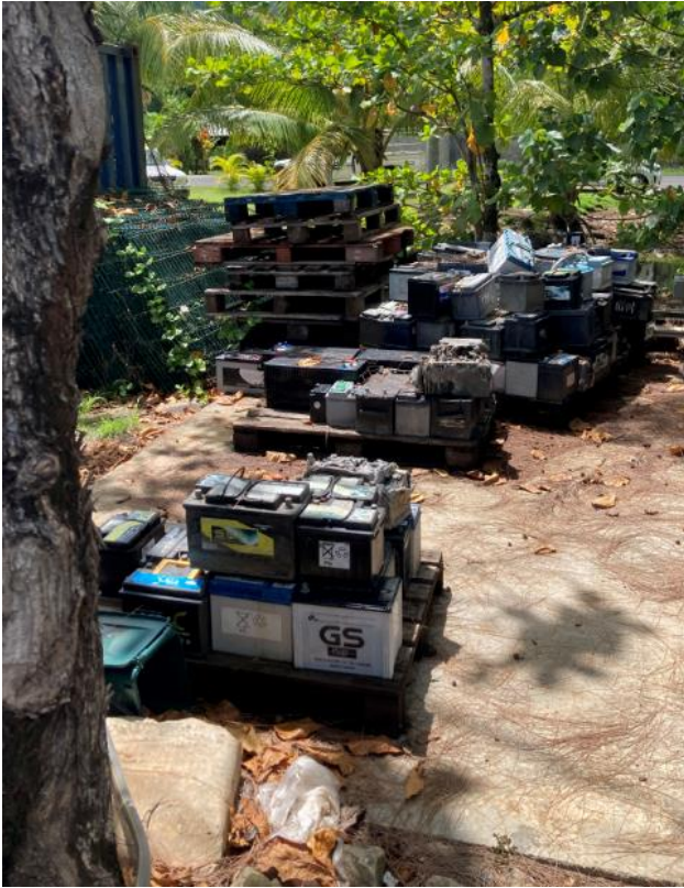
Image 16: Stockage sans bac de rétention bétonné et non couvert
